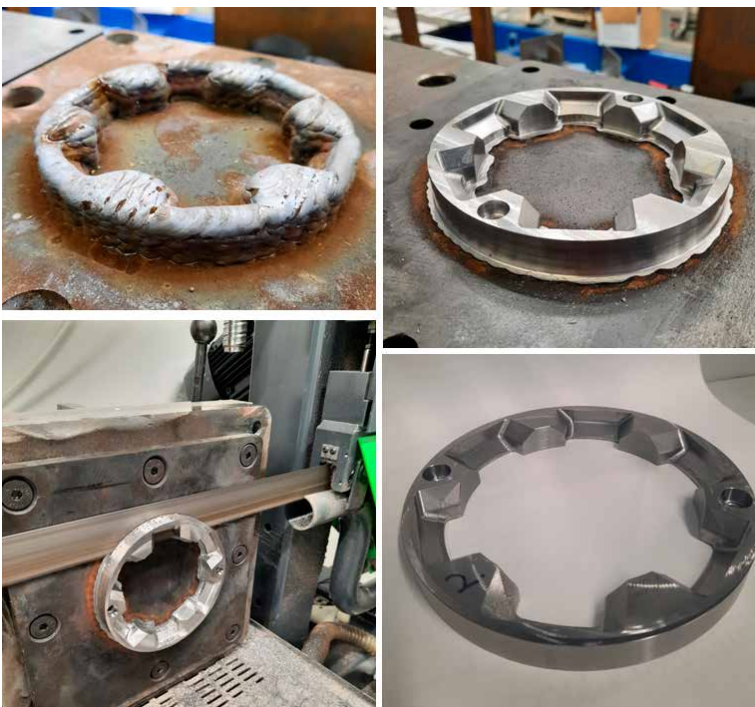
Kuva 9. Vaiheita WAAM-valmistuksesta ja valmis tuote.
