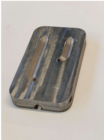
Epäonnistuneesta keernasta sahattu näyte, yläpuoli
